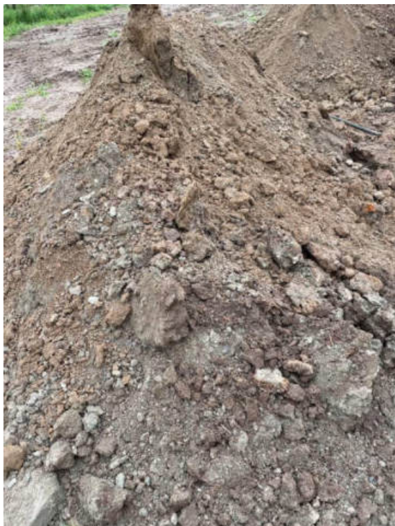
Abb. 14: Schurf SCH 5, obere Auffüllungsschicht. Bauschuttanteil gering (1-3 %). Vereinzelt Beton-, Ziegel und Asphaltreste enthalten.
