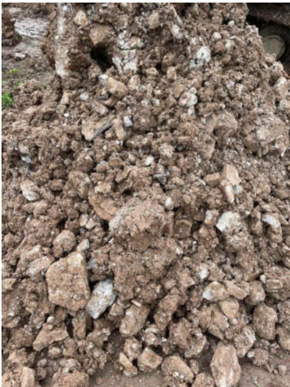
Abb. 12: Schurf SCH 4, Bodenaushub aus 3,0-5,0 m Tiefe. Augenscheinlich frei von Bauschutt.
