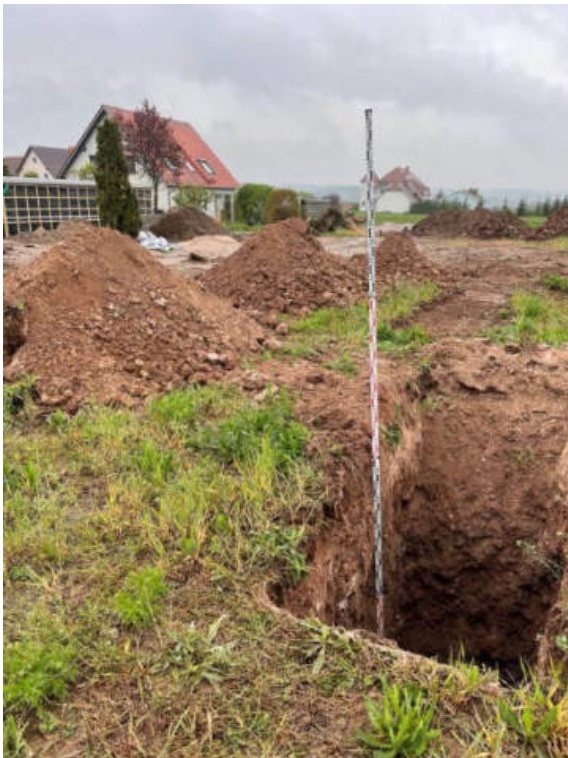
Abb. 4: Schurf SCH 2, Nordwestrand ehemaliger Steinbruch (älterer Teil), Obere Bodenschicht ohne erkennbare Bauschuttanteile
