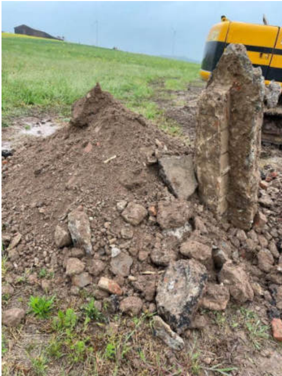
Abb. 21: Schurf SCH 7, Auffüllungsschicht zwischen 1,5 und 5,50. Bauschuttanteil (Beton, Ziegel, Asphalt) bei ca. 15-20 %.
