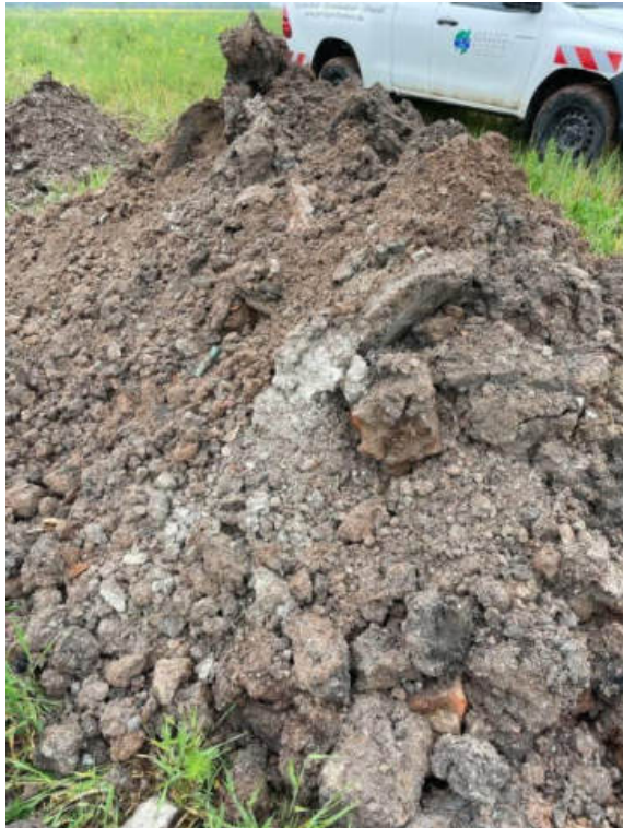
Abb. 15: Schurf SCH 5, untere Auffüllungsschicht. Geringer Bauschutt- und Müllanteil (ca. 1-3 %. Ziegel-, Beton, Kunststoffreste)
