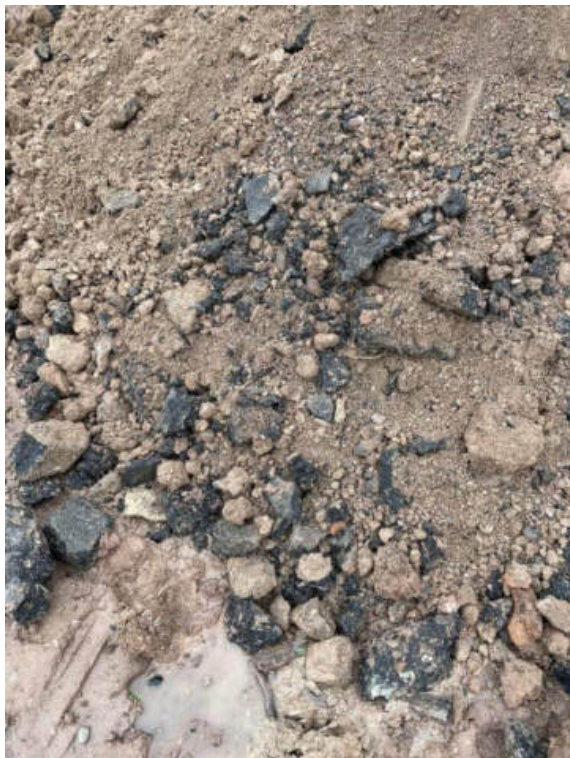
Abb. 10: Schurf SCH 4, obere Auffüllungsschicht. Bauschuttanteil (Asphalt, untergeordnet Beton) bei ca. 5- 10 %.
