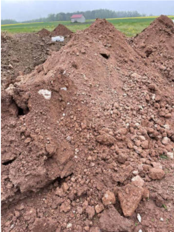
Abb. 7: Schurf SCH 3, obere Auffüllungsschicht. Bauschuttanteil (Beton, Asphalt) gering
